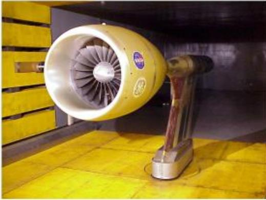
Физическая модель турбореактивного авиационного двигателя
