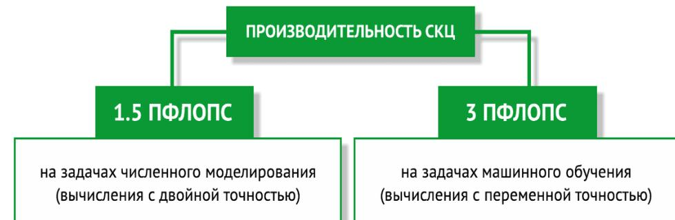
668 узлов CPU+GPU /Nvidia A100 + 20 узлов FPGA, сетевая инфраструктура – 10-56 Гбит/с, Потребление энергии – 1МВт
